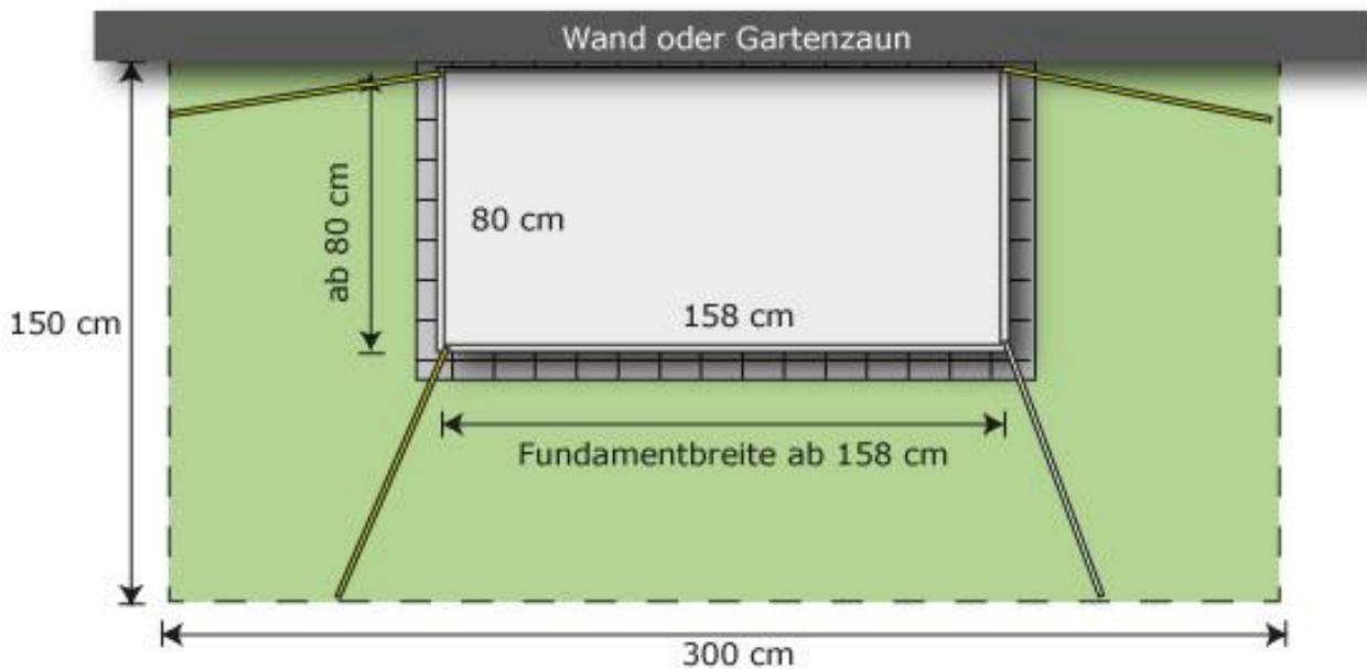
Als Fundament dienen bereits einfache Gehwegplatten oder sonst ein fester, möglichst ebener Untergrund
